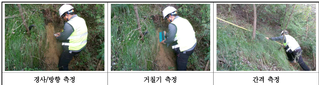
【사진 21.3.3】 불연속면 측정 현황
